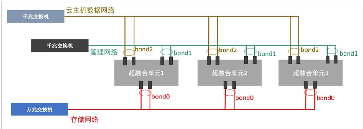
管理员根据上述的网络架构图，对网络设备和服务器进行上架并连线。
